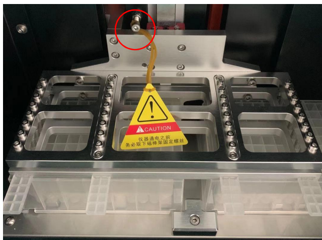
图 3-1. 磁棒架固定螺丝安装示意图
